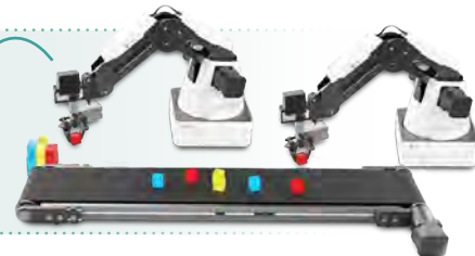
297656 LINEA DI PRODUZIONE CON NASTRO TRASPORTATORE E 2 BRACCI ROBOTICI
