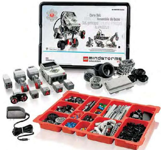
Questo sistema è basato sul mattoncino intelligente EV3 Brick, un piccolo ma potente computer programmabile che consente di controllare il motore e leggere i feedback dei sensori
