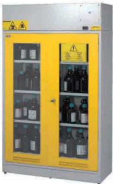
Costruito interamente in acciaio decapato ed elettrozincato, spessore 10/10 con verniciatura a polveri epossidiche antiacido applicate elettrostaticamente con successivo passaggio in galleria termica a 200° C.
