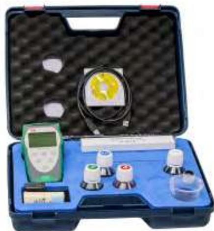
pHmetro portatile con gestione dei sensori digitali DHS a tripla alimentazione (tramite PC, rete e batterie) con uscita USB per collegamento a PC.
