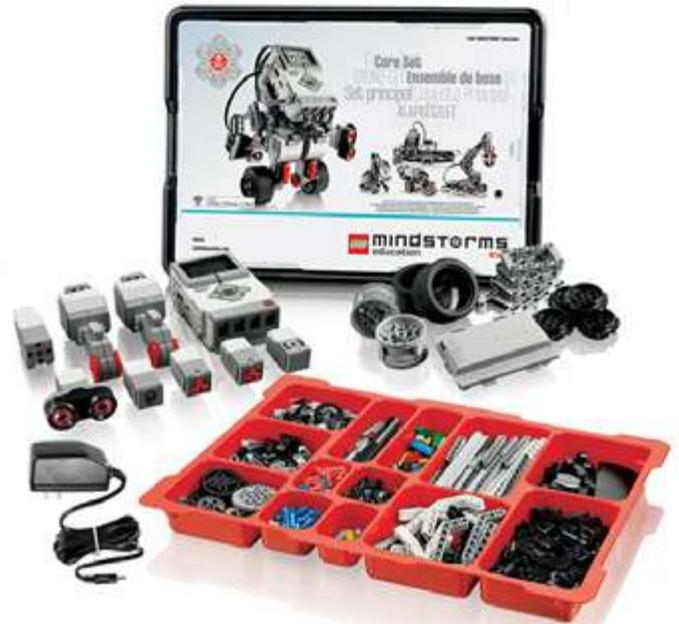
Questo sistema è basato sul mattoncino intelligente EV3 Brick, un piccolo ma potente computer programmabile che consente di controllare il motore e leggere i feedback dei sensori
