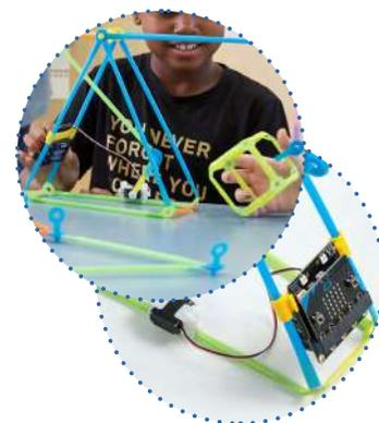
**micro:bit** è una piccola scheda programmabile che può essere utilizzata per insegnare i rudimenti della programmazione. Misura 4x5 cm e integra 25 LED (5x5), presenta due pulsanti programmabili e cinque anelli I/O, per connettere dispositivi o sensori esterni. Monta un processore ARM Cortex M0 a 32 bit con Bluetooth, una bussola digitale-magnetometro, un accelerometro e un connettore microUSB. Può essere inclusa (338225) oppure non inclusa (338226) nello STEAM e micro:bit starter kit.
