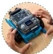
mBot2 include inoltre dei sensori di ultima generazione: 2 sensori ad ultrasuoni, sensori di colore Quad RGB con 4 punti di rilevazione al tempo stesso, perfetti anche per attività "seguilinea" estremamente precise.
